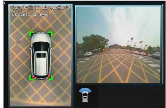
ADAS360°アラウンドビューモニターシステムは、車両に取り付けた前後左右の4カ所のカメラにて、車両を真上から眺める感覚で外周（アラウンド）を把握でき、つなぎ目のないシームレス映像にて死角を作らず、発進時や駐車時などでの周囲の安全確認を容易とします。
